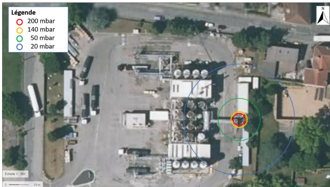
Figure 30 : Effets de surpression suite à l'explosion des bouteilles de propane
