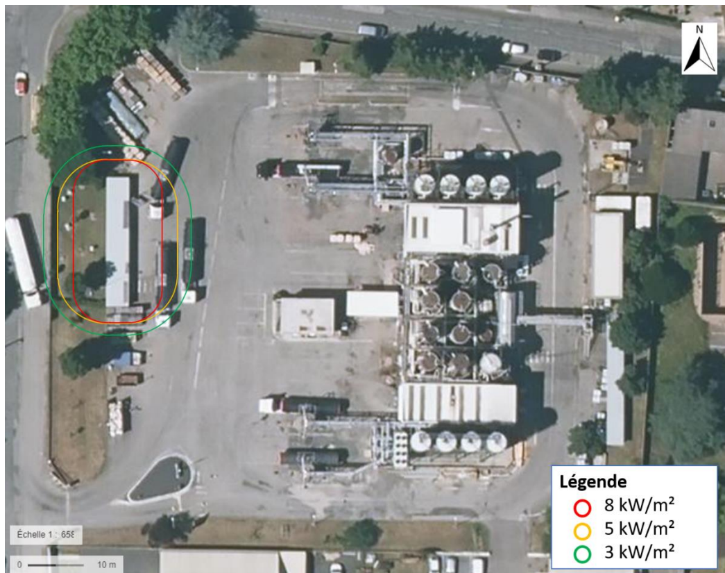
Figure 27 : Effets thermiques en cas d'incendie du stockage de polymères sous abri
