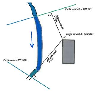
Cote de la crue de référence = Cote amont  $-\frac{Cote \ amont - Cote \ aval}{Distance \ amont + Distance \ aval} \times Distance \ amont$
