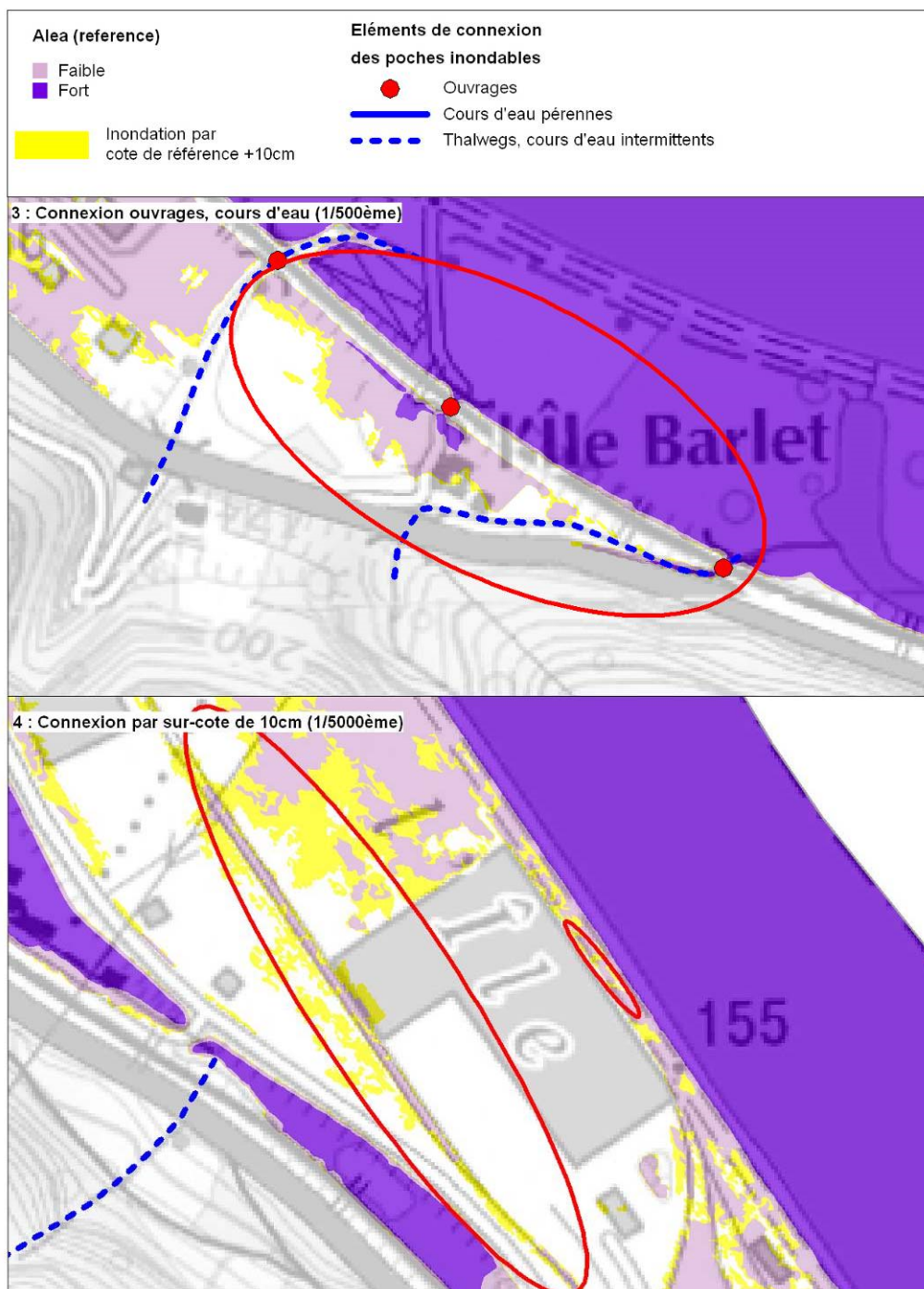
Figure 8 : traitement des poches isolées (2/2)
