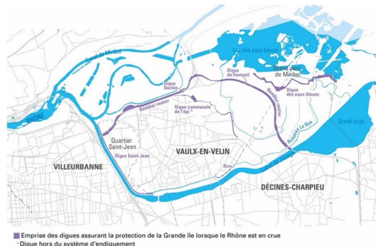
**Figure 7 : Schéma de localisation des digues assurant la protection de la Grande île lorsque le Rhône est en crue**
