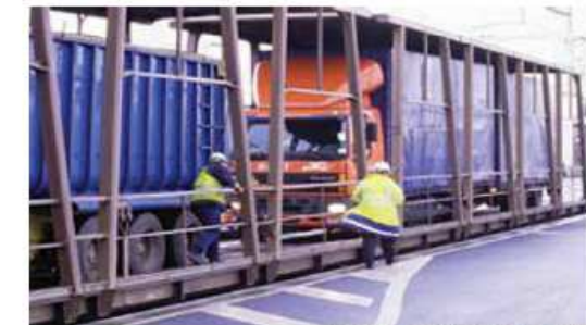
Autoroute Ferroviaire à Grand Gabarit (Source : Eurotunnel).
