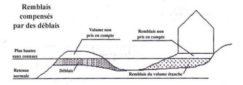
La compensation « **cote pour cote** » signifie que le déblai est positionné aux mêmes altitudes en mètres NGF que le remblai, c'est-à-dire que la courbe hauteur NGF - volume du déblai doit être identique à la courbe hauteur NGF - volume du remblai.
