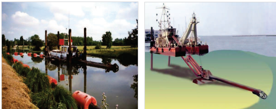
Figure 6 : Photo et schéma d'une drague aspiratrice stationnaire
